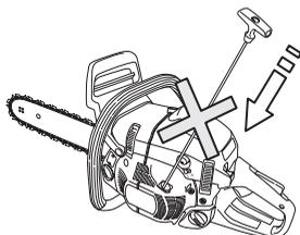
**Remarque!** Tirer l'arceau protecteur vers la poignée avant. Le frein de chaîne est alors libéré. La tronçonneuse est maintenant prête à être utilisée.
