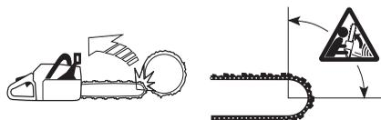
Le tronçonnage avec la partie inférieure de la chaîne, c'est à dire par dessus (de haut en bas), s'appelle méthode "poussée". La tronçonneuse est attirée vers l'arbre et le bord avant de la tronçonneuse devient un appui naturel contre l'arbre. Dans ce cas, l'utilisateur contrôle mieux à la fois sa tronçonneuse et la zone de rebond du nez.
