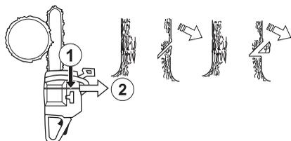
L'encoche doit faire 1/4 du diamètre du tronc et l'angle entre les deux entailles doit être d'au moins 45°.
