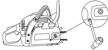
La chaîne est tendue correctement quand elle ne pend pas sous le guide et peut toujours être avancée à la main sans difficulté. Serrer l'écrou du guide-chaîne avec la clé universelle tout en maintenant relevé le nez du guide.
