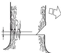
Le trait de chute doit s'achever parallèlement à l'encoche, l'espace entre les deux étant 1/10 du diamètre du tronc. La partie non coupée du tronc s'appelle la charnière.
