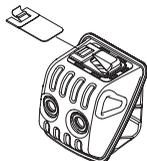
Le silencieux est conçu pour atténuer le bruit et dévier le flux des gaz d'échappement loin de l'utilisateur. Ces gaz sont chauds et peuvent transporter des étincelles risquant de causer un incendie si elles entrent en contact avec un matériau sec et inflammable.
