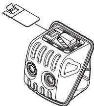
Lors du montage de la grille, veillez à ce qu'elle soit placée dans la position adéquate. Utilisez la clé mixte pour placer ou détacher la grille, si besoin est.
