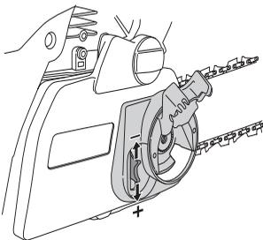
La chaîne est tendue correctement quand elle ne pend plus sous le guide et peut encore être tournée facilement à la main. Tenir le nez du guide et serrer l'embrayage du
