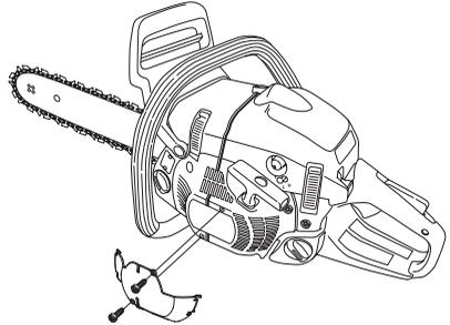
**REMARQUE!** Si le kit spécial hiver est utilisé ou si des mesures sont prises pour augmenter la température, il convient de revenir au réglage normal, dans la mesure où la machine est alors utilisée dans des conditions de températures normales. Sinon il y a risque de surchauffe avec pour conséquence de graves dommages au moteur.
