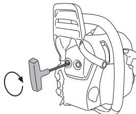
Certains silencieux sont munis d'une grille antifiemme. Cette grille doit être nettoyée une fois par semaine si la machine en est équipée. Utiliser de préférence une brosse en acier. Un pare-étincelles colmaté risque de causer la surchauffe du moteur et de provoquer de sérieuses avaries du moteur.
