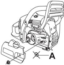
Monter le guide-chaîne sur le boulon du guide. Placer le guide sur sa position la plus reculée. Placer la chaîne sur le pignon d'entraînement et dans la rainure du guide-chaîne. Commencer par le dessus du guide-chaîne.
