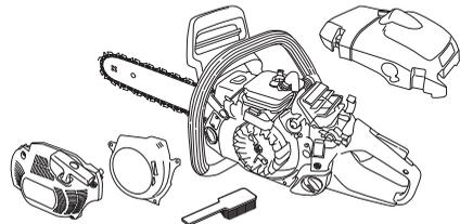
Nettoyer le système de refroidissement avec une brosse une fois par semaine, voire plus souvent dans des conditions difficiles. Un système de refroidissement sale ou colmaté provoque la surchauffe de la machine, endommageant le cylindre et le piston.
