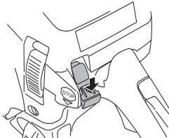
REMARQUE! Le bouton marche/arrêt retourne automatiquement en mode de conduite. Afin d'éviter tout démarrage accidentel, toujours retirer le capuchon de la bougie lors du montage, contrôle et/ou entretien.
