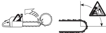
Le rebond se produit toujours dans le plan du guide-chaîne. En général, tronçonneuse et guide-chaîne sont relevés simultanément en direction de l'utilisateur. Néanmoins, la direction du rebond peut varier suivant la
