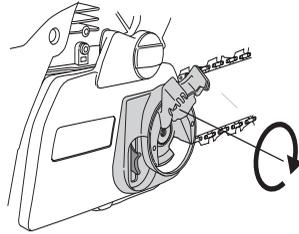
La tension d'une chaîne neuve doit être vérifiée fréquemment pendant son rodage. Vérifier régulièrement la tension. Une tension correcte est synonyme de bonne capacité de coupe et de longue durée de vie.
