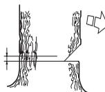
Τοποθετήστε τον οδοντωτό προφυλακτήρα (εάν έχει τοποθετηθεί) ακριβώς πίσω από το κομμάτι ξύλου που είναι έτοιμο να πέσει. Εφαρμόστε φουλ γκάτζι και
