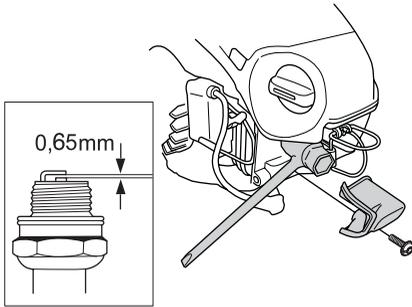
Σημώση! Χρησιμοποιείτε πάντοτε τον τύπο μπουζιού που συστήνεται! Λάθος τύπος μπορεί να προκαλέσει ζημιά στο έμβολο/κύλινδρο. Ελέγξτε αν το μπουζί είναι εφοδιασμένο με συμπίεστή.
