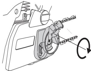
El tensado de una cadena nueva debe controlarse con frecuencia, hasta que se haya hecho el rodaje. Controle el tensado regularmente. Una cadena correcta significa buena capacidad de corte y larga duración.
