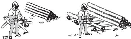
**El tronco en el suelo.** No hay riesgo de atasco de la cadena o de partición del objeto de corte. Sin embargo, hay un riesgo considerable de que la cadena toque el suelo después del corte.
