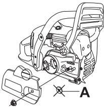
Monte la espada sobre el perno de la espada. Coloque la espada en la posición posterior extrema. Coloque la cadena sobre el piñón de arrastre y en la guía de la espada. Empiece con la parte superior de la cadena.
