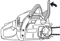
Suelte la rueda tensora de cadena y quite la cubierta del embrague (freno de cadena). Quite la protección de transporte. (A)
