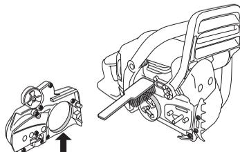
Controle periodicamente se restam pelo menos 0,6 mm da espessura da cinta nas partes de maior desgaste.
