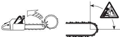
O retrocesso desloca-se sempre na direcção do plano da lâmina. Mais comum é que a moto-serra e a lâmina sejam arremessadas para cima e para trás, contra o utilizador. Entretanto, ocorrem outras direcções de retrocesso, dependendo da posição da moto-serra no momento em que o sector de risco de retrocesso a lâmina entrou em contacto com um objecto.
