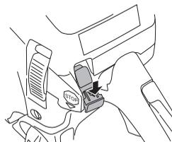
El motor se arranca presionando el mando de arranque/parada.
