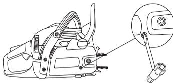
A corrente está correctamente esticada quando não mais pender na parte inferior da lâmina e ainda possa ser girada facilmente com a mão. Aperte bem a porca da lâmina com a chave universal, mantendo simultaneamente a extremidade da lâmina para cima.
