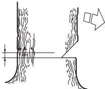
Coloque o apoio para casca (se estiver montado) atrás da linha de ruptura. Serre com aceleração total e deixe a corrente/lâmina penetrar devagar na árvore. Observe se a árvore se move no sentido contrário ao da direcção de queda pretendida. Introduza uma cunha de abate ou barra extractora logo que a profundidade de corte o permita.
