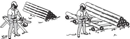
**O tronco está deitado sobre o solo.** Não há nenhum risco da corrente se prender ou de fendilhamento do objecto a serrar. O risco é, entretanto, grande de que a corrente toque o solo após a serração de fora a fora.
