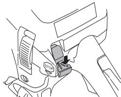
¡NOTA! El contacto de arranque/parada retorna automáticamente a la posición de marcha. Por consiguiente, para evitar el arranque involuntario hay que quitar siempre el capuchón de encendido de la bujía antes de realizar trabajos de montaje, control y/o mantenimiento.
