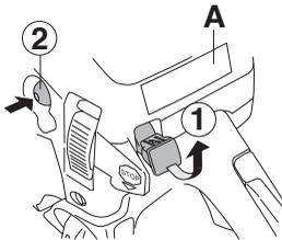
Segure no punho dianteiro com a mão esquerda. Mantenha a moto-serra no chão colocando o pé direito através do punho traseiro. Puxe o punho de arranque com a mão direita e puxe a corda de arranque lentamente até começar a sentir resistência (quando os predadores do arranque engatam). De seguida, puxe firme e rapidamente até que o motor dispare (3).
