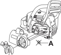
Monte a lâmina nos seus parafusos. Coloque a lâmina na sua posição mais atrás. Ponha a corrente sobre o pinhão e a ranhura da lâmina. Comece pela parte superior da lâmina.
