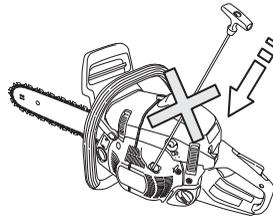
**Observe!** Rearme o travão da corrente levando a protecção contra o retrocesso em direcção ao arco dos punhos. A moto-serra está agora pronta a ser usada.
