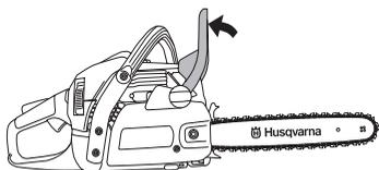
Desatarraxe e retire a porca da lâmina e remova a cobertura do acoplamento (travão de corrente). Retire o protector para transporte (A).
