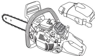
Uma limpeza mais completa obtém-se ao lavar o filtro com água e sabão.
