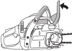
Desapertar a roda esticadora da corrente e desmontar a cobertura da embraiagem (travão da corrente) Desmonte a protecção de transporte. (A)
