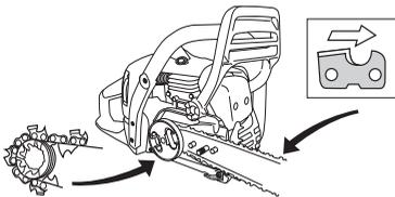
Compruebe que los filos de los eslabones de corte estén orientados hacia delante en la parte superior de la espada.
