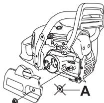
Monte a lâmina sobre o parafuso da lâmina. Coloque a lâmina na posição mais recuada. Ponha a corrente sobre o pinhão e na ranhura da lâmina. Comece pela parte superior da lâmina.
