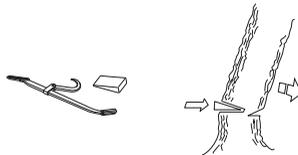
Recomendamos o uso de um comprimento de lâmina superior ao diâmetro do tronco na copa da árvore, de modo que o corte de abate e o corte direccional possam ser executados com o chamado 'corte simples'. Ver o capítulo Especificações técnicas com relação ao comprimento de lâmina adequado ao seu modelo de motosserra.
