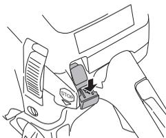
O motor arranca carregando no comando de arranque/paragem.
