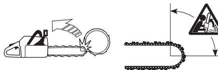
El corte con la parte inferior de la espada, en sentido descendente desde la parte superior del objeto a cortar, se denomina de corte con cadena tirante. La motosierra es tirada hacia el árbol y el canto delantero del cuerpo se apoya contra el tronco. Con esta técnica de cadena tirante, el usuario controla mejor la motosierra y la situación del sector de riesgo de reculada de la espada.
