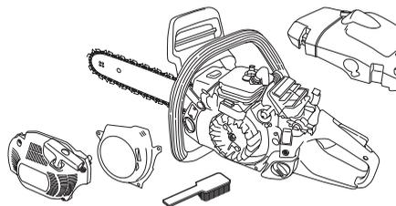
Limpie el sistema refrigerante con un cepillo una vez por semana (en condiciones difíciles, con mayor frecuencia). Un sistema refrigerante sucio u obturado produce sobrecalentamiento de la máquina, con las consiguientes averías del cilindro y el pistón.
