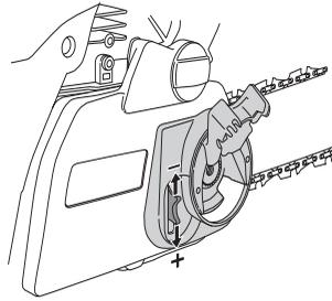
A corrente está correctamente esticada quando não pende na parte inferior da lâmina, mas pode ainda ser rodada facilmente à mão. Segure a ponta da lâmina e aperte a embraiagem da lâmina rodando o manipulo para a direita.
