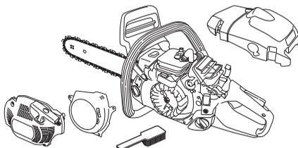
Limpe o sistema de arrefecimento com uma escova, uma vez por semana, ou com mais frequência, em condições de trabalho difíceis. O sistema de arrefecimento obstruído ou sujo conduz a um sobreaquecimento da máquina, danificando o cilindro e o pistão.
