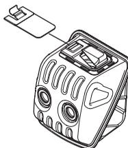
Ao colocar a rede, assegure-se de que esta é inserida na posição correcta. Caso seja necessário, utilize a chave universal para inserir ou remover a rede.
