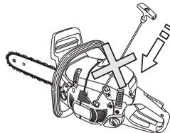
**Aclaración!** Para poner el freno de cadena en su posición inicial, mueva la protección contra reculadas hacia la empuñadura del mango. Ahora, la motosierra está lista para funcionar.
