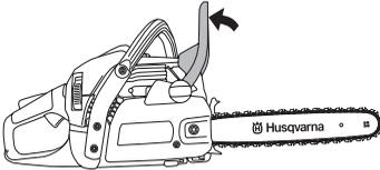
Desenrosque la tuerca de la espada y desmonte la carcasa del embrague (el freno de cadena). Saque la protección de transporte (A).
