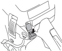
**NOTA!** O interruptor de Arranque/Paragem retorna automaticamente à posição de operação. Por isso, para impedir o arranque accidental da máquina, deve-se sempre remover a protecção da vela de ignição durante todos os trabalhos de montagem, inspecção e/ou manutenção.
