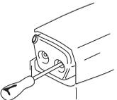
Ορισμένοι σιγαστήρες έχουν ένα ειδικό δικτυωτό φίλτρο σπινθήρων. Αν το μηχανήμα σας έχει έναν τέτοιο σιγαστήρα, θα πρέπει να καθαρίζετε το δικτυωτό φίλτρο μια φορά τη βδομάδα. Χρησιμοποιήστε για καλύτερο αποτέλεσμα μια ασαλόβουρτσα. Ένα βουλωμένο δίχτυ προκαλεί υπερθέρμανση του κινητήρα με σοβαρή βλάβη του ως αποτέλεσμα.
