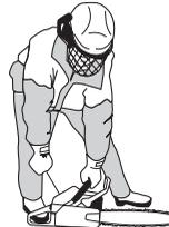
Επειδή το αλυσόφρενο εξακολουθεί να είναι συνδεδεμένο, πρέπει οι στροφές κινητήρα το ταχύτερο δυνατό να πέσουν στο ρελαντί, κάτι που γίνεται γρήγορα με αποσύνδεση της ασφάλειας γκαζιού. Έτσι
