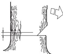
Τοποθετήστε τον οδοντωτό προφυλακτήρα (αν έχει το μηχάνημα) πίσω από τη λωρίδα ανατροπής. Δώστε φουλ γκάζί και πριονίστε με αργή κίνηση. Προσέχετε συγχρόνως μήπως το δέντρο κινείται προς αντίθετη κατεύθυνση απ' αυτήν που διαλέξατε. Βάλτε μια σφήνα ή μια μπάρα ανατροπής στην τομή πτώσης μόλις πριονίσετε στο κατάλληλο βάθος.
