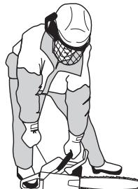
После того, как двигатель сделает первую вспышку, верните сразу рычаг воздушной заслонки в первоначальное положение, открывая воздушную заслонку, и повторите запуск. Когда двигатель запустится, дайте полный газ и отпустите рычаг дроссельной заслонки и блокировка пускового положения дроссельной заслонки отключится.
