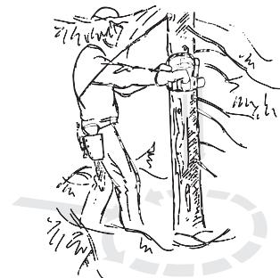
木の周辺の下草や茂みを払い、木が倒れ始めたときの退避路に障害物（石や枝、穴など）がないかどうかを確認します。木が倒れ始めたときの退避路に障害物がないかどうかを確認します。退避路は、伐倒見込み方向から約 135 度の角度になるように取ります。
