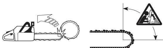
ガイドバーの下側で切る方法、つまり木の上から下に向かって切る方法を引き切りといいます。このときチェンソーは自ら木のほうに引き寄せられ、チェンソー本体の前端がちょうど幹に乗る格好となります。引き切りの方が、チェンソーとキックバックゾーンの位置の制御が簡単です。
