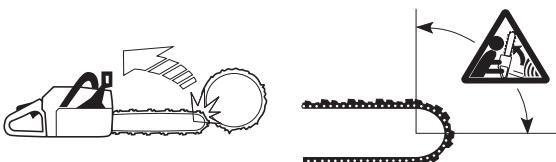
キックバックは、常にガイドバーの鋸断面で起こります。通常、チェンソーがガイドバーを先にして、使用者の方に斜め上にはじき返されます。ただし、キックバックゾーンが何かに触れたときのチェンソーの使い方により、異なる方向にはじき返されることもあります。
