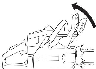
Отвинтите гайки крепления пильного полотна и снимите крышку муфты сцепления (тормоза цепи). Снимите транспортировочное кольцо (A).
