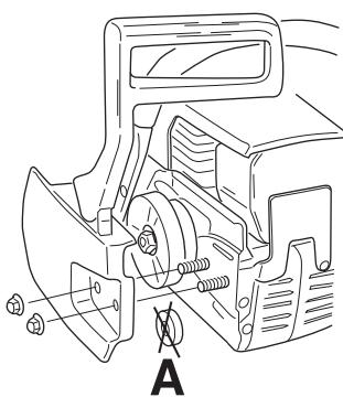
Установите пильное полотно на специально предназначенные болты. Установите полотно в самое заднее положение. Оденьте цепь на ведущую звездочку и вставьте ее хвостовики в паз пильного полотна. Начинайте с верхней стороны пильного полотна. Убедитесь, что кромки режущих звеньев направлены вперед на верхней стороне пильного полотна.
