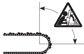
Отдача всегда происходит в плоскости резания пилы. Обычно при отдаче моторную пилу отбрасывает назад и вверх в направлении рабочего. Тем не менее моторная пила в момент отдачи может двигаться в различных направлениях в зависимости от метода резки, который применялся в момент касания зоны отдачи полотна и объекта.
