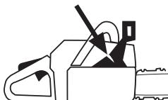
Движете аварийния лост напред и назад, за да проверите дали той се движи свободно и е надеждно закрепен към капака на съединителя.
