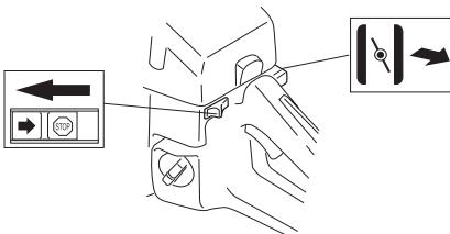
Ако машината е оборудвана с декомпресационен вентил (A): Натиснете вентила, за да намалите налягането в цилиндъра и да облекчите стартирането на машината. Използвайте винаги декомпресационния вентил при стартиране. След стартиране на машината вентилът се връща автоматично в изходното си положение.
