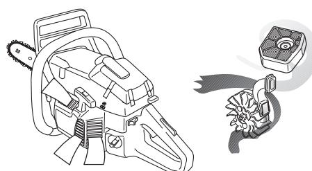
**ЗАПОМНЕТЕ!** За да действа центробежното почистване е необходимо да се провежда редовна поддръжка. Почистете устройството за засмукване на въздуха в стартера, перките на вентилатора на маховика, пространството около маховика, входната тръбичка и пространството на карбуратора.
