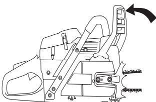
Отвинтете гайките на шината и свалете капака на съединителя. Свалете защитата за транспортиране (A).
