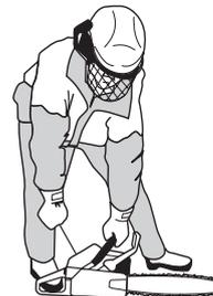
エンジンに点火したら直ちにチョークコントロールを押し込み、エンジンが始動するまでロープを引き続けます。エンジンが始動したら、すぐフルスロットルにします。スロットルスタートロックは自動的に解除されます。
