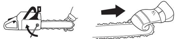
チェンの張り調整ネジの位置は、チェンソーのモデルによって異なります。お持ちのチェンソーの調整ネジの位置を「各部名称」でご確認ください。
