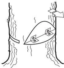
Возможность влияния на направление падения будет полностью утрачена, если полоса разлома слишком узкая или пропилована направляющий и основной пропилами плохо размещены.
