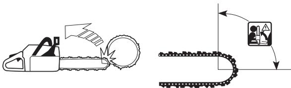
Резка нижней кромкой полотна, т.е. от поверхности объекта к нижнему краю известна как пиление с нажимом. В этом случае моторная пила сама наезжает на дерево и передний край моторной пилы соответствует естественному положению при резке. Пиление с нажимом обеспечивает лучший контроль над моторной пилой и расположением области отдачи.
