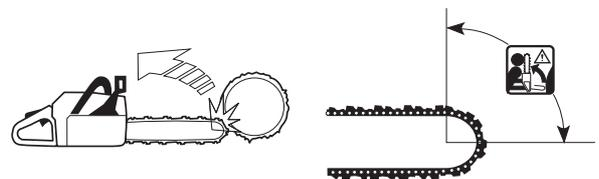
Отдача всегда происходит в плоскости резания пилы. Обычно при отдаче моторную пилу отбрасывает назад и вверх в направлении рабочего. Тем не менее моторная пила в момент отдачи может двигаться в различных направлениях в
