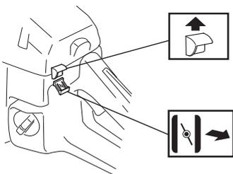
Если машина оборудована декомпрессионным клапаном (А): Его необходимо нажать, чтобы уменьшить давление в цилиндре и облегчить запуск машины. При запуске машины всегда
