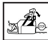
Если на Вашей машине имеется такая наклейка, значит она оснащена катализатором.
