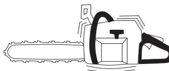
Verifique se os elementos anti-vibração estão fixos entre a parte do motor e a parte dos punhos.
