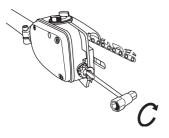
3 Stringere il dado della lama con la chiave combinata tenendo sollevata la punta della lama. Controllare che la catena possa essere fatta girare manualmente con facilità.
