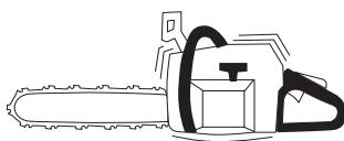
One vibracije kojima se bude izloženo kod svake upotrebe motorne pile, su iz razloga što je neravnomjeran kontakt između motornog lanca i drveta u toku rezanja.
