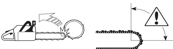
Kada se pila sa donjom stranom mača tj. sa gornje strane predmeta koji se pila prema dole to se naziva povlačenje lanca pile. Tada se povlači motorna pila prema drvetu i prednji kraj tјela motorne pile postaje prirodni oslonac prema deblju. Pilanje sa povlačenjem lanca pile daje rukovaocu bolju kontrolu nad motornom pilom i nad položajem gdje se nalazi rizično područje mača.
