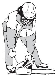
Obuhvati prednji rukohvat sa lijevom rukom a desnu nogu postavi na donji dio stražnjeg držača i pritisni motornu pilu prema tlu. Uhvati ručicu za paljenje, povuci desnom rukom polako uže za paljenje dok ne osjetiš otpor (startne kvake hvataju) i učini iza **Nikad ne omotavaj startno uže oko šake.**
