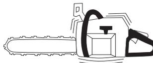
As vibrações a que o utilizador é submetido ao usar a moto-serra, têm sempre origem no contacto "irregular" entre a corrente e a madeira durante a serração.
