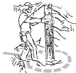
Remova a vegetação do solo em volta da árvore e prepare-se para eventuais obstáculos (pedras, galhos, buracos, etc.) de modo que possa fugir facilmente quando a árvore começar a cair. O caminho de fuga deve estar situada a cerca de 135° diagonalmente para trás da direcção de abate planeada para a árvore.
