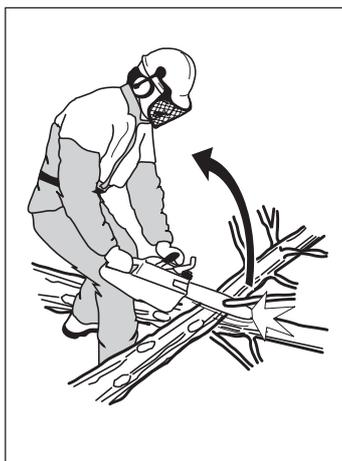
4 Nunca use a serra acima da altura dos ombros e evite serrar com a ponta da lâmina. **Nunca use a serra segurando-a apenas com uma das mãos.**
