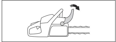
2. Coloque el interruptor de arranque/parada en la posición de arranque (ON).
