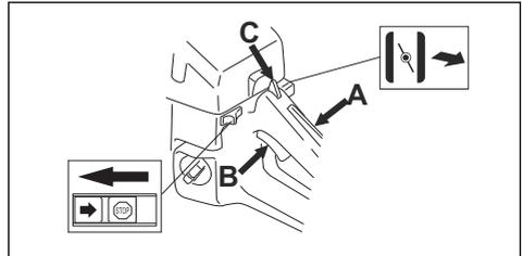
7. Presione la válvula de descompresión.
