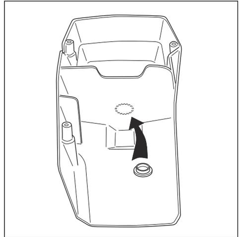
2. Hay disponible una cubierta de invierno para trabajar a temperaturas inferiores a  $-5^{\circ}\text{C}$  ( $23^{\circ}\text{F}$ ) o con nieve. Monte la cubierta de invierno en el cuerpo del mecanismo de arranque. La cubierta de invierno disminuye el flujo de aire frío y evita la entrada de una gran cantidad de nieve en la zona del carburador.
