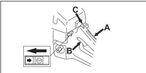
6. Presione la válvula de descompresión.
