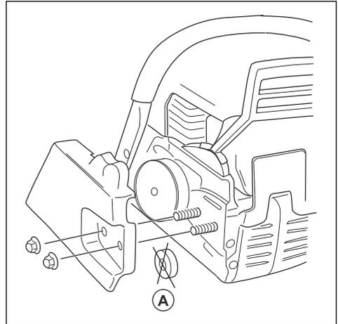
**Nota:** Si la cubierta del embrague es difícil de quitar, apriete la tuerca de la espada, accione el freno de cadena y suéltelo. Se oirá un clic si se suelta correctamente.
