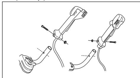
3. Центрирайте отвора на винта в дръжката на газта с отвора в удължителя.
