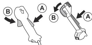
3. Пуснете ръкохватката и се уверете, че блокировката на регулятора за газта (A) и регуляторът за газта (B) се връщат в първоначалното си положение.
