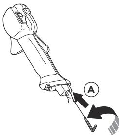
4. Ако оборотите на стартовата газ са повече от 6500 rpm, завъртете регулиращия винт (A) обратно на часовниковата стрелка. Когато режещото оборудване започне да се върти, завъртете регулиращия винт (A) на 1/2 оборот.
