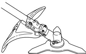
3. Подменете предпазителя на режещото оборудване, ако бъде повреден.
