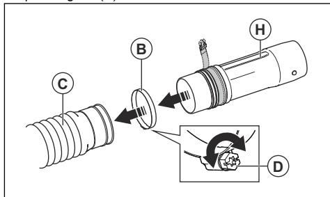
5. Veenduge, et klambrikuvi (D) on asetatud vastavalt joonisel näidatule. Pingutage kruvi.
