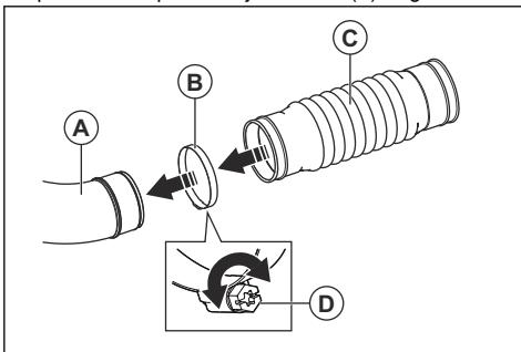
2. Veenduge, et klambrikuvi (D) on asetatud vastavalt joonisel näidatule. Pingutage kruvi.
