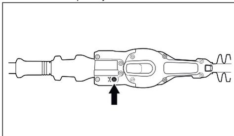
2. Gire el tornillo hacia la derecha o hacia la izquierda para inclinar fácilmente el equipo de corte.
