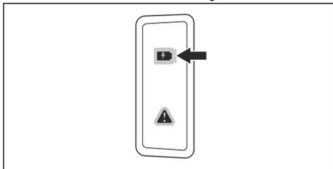
4. Cuando todos los LED de la batería se hayan encendido, la batería estará totalmente cargada.
