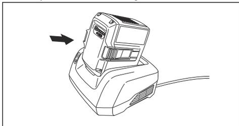
3. Asegúrese de que se enciende la luz de carga verde en el cargador. Eso significa que la batería está conectada correctamente al cargador.
