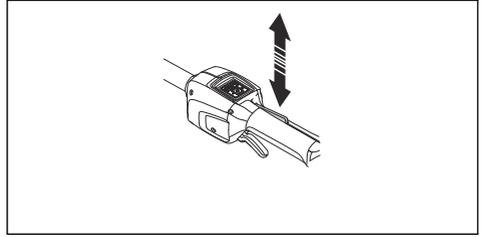
3. Compruebe que el gatillo de alimentación y el bloqueo se mueven sin problemas y que el muelle de retorno funciona correctamente.
