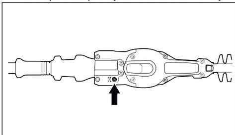
2. Rode o parafuso para a direita ou para a esquerda para inclinar facilmente a plataforma de corte.
