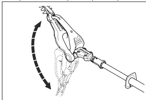
4. Suelte la empuñadura de ajuste de la posición para bloquear el equipo de corte.
