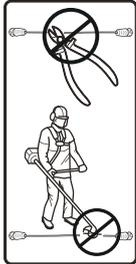
El cable de voltaje bajo no se debe acortar, extender ni empalmar.
