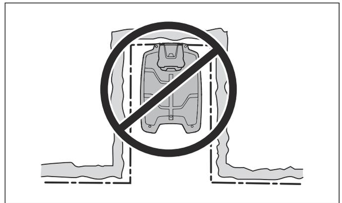
La estación de carga debe colocarse sobre una superficie nivelada. El extremo delantero de la estación de carga no se puede colocar en una posición superior o inferior en comparación con la parte posterior de acuerdo con la imagen a continuación.
