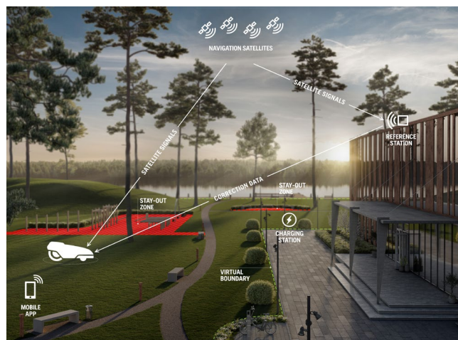
Husqvarna EPOS-teknologi är ett satellitnavigeringssystem som används för att skapa virtuella gränser för professionella robotgräsklippare.
